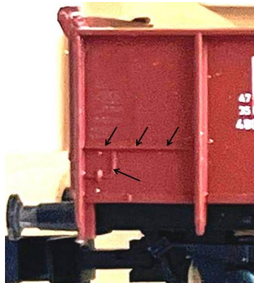
Fig. 1 Remover os relevos: da barra assinalada com 3 setas; e da caixa de registos, 1 seta em baixo
