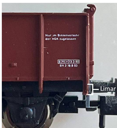
Fig. 4 Zona da barra lateral a limar para ficar lisa.
